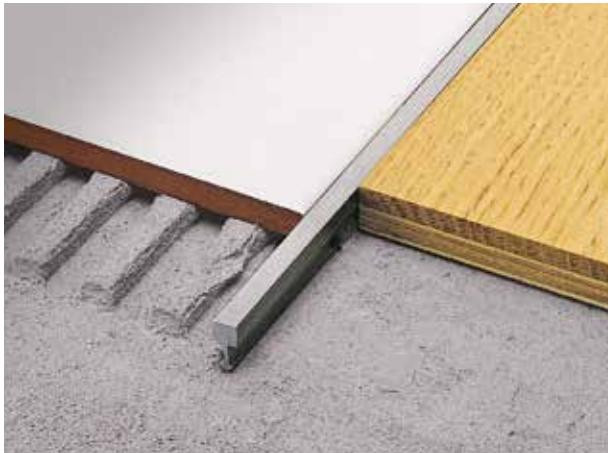
I profili linetec AD frazionano pavimenti allo stesso livello posati a colla, offrendo una superficie in vista di 5 mm. Lo spessore della testa di 4 mm, ne consente la levigatura contestuale al pavimento. Il particolare gambo a freccia garantisce un aggrappaggio meccanico resistente con il collante usato. Ideale l'abbinamento con pavimenti in marmo o legno.
